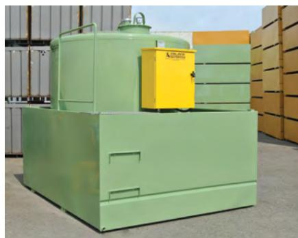
I Tank Fuel sono inoltre dotati di un sistema di erogazione che può essere contenuto all'interno di un apposito armadio metallico oppure essere costituito da un distributore di carburante.
