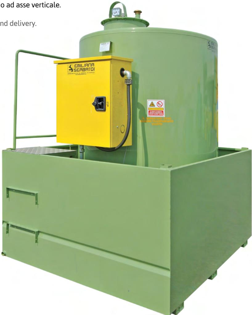
I serbatoi sono del tipo ad asse verticale, cilindrici, costruiti con fondi bombati e lamiera calandrata in acciaio al carbonio S 235 JR UNI EN 10025, assemblati mediante processo di saldatura ad arco sotto protezione di gas e successivamente trattati con uno strato di antiruggine ed uno strato di smalto a finire di colore verde; sono collaudati a tenuta mediante prova pneumatica.
